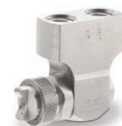
1/8JAC and 1/4JAC — Входные соединения для воздуха и жидкости находятся на одной стороне корпуса форсунки под углом в 90° относительно направления распыления
