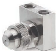
6552-1/8JAC — Миниатюрная конструкция толщиной всего 1/2" с прямоугольной поверхностью 1-5/32" на 1-1/4". Входные соединения для воздуха и жидкости находятся на одной стороне корпуса форсунки под углом в 90° относительно направления распыления
