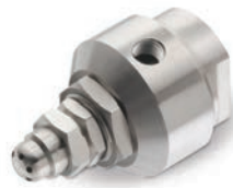
1/2JBCJ — Форсунка с рубашкой парового обогрева для распыления жидкостей со слишком высокой вязкостью для распыления при комнатной температуре
