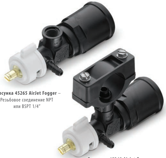
Форсунка 45269 AirJet Fogger – Монтажный зажим split-eyelet для быстрого монтажа форсунки на линии подачи жидкости. Дополнительной трубной арматуры не требуется. Нарезать резьбу, отрезать или спаивать трубу не требуется.
