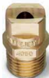
Н-U Соединение с наружной резьбой от 1/8" до 3/4" Расход от 1 гал/мин и более при давлении 40 psi (от 3,8 л/мин и более при давлении 2,8 бар)
