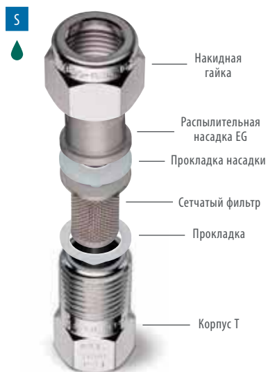
Распылительная насадка EG + Корпус 11430 Используется с прокладкой, сетчатым фильтром, прокладкой насадки и накидной гайкой распылительной насадки высокого давления
