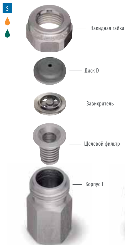
Распылительная насадка D + корпус Т Соединение с внутренней резьбой 1/4" Исполнение с диском и завихрителем Используется с фильтром с пазами и накидной гайкой
