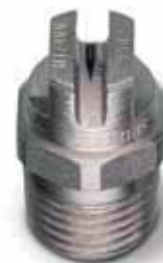
Н-VV и Н-VVL Соединение с наружной резьбой от 1/8" до 1/4" Расход до 1 гал/мин при давлении 40 psi (до 3,8 л/мин при давлении 2,8 бар) Н-VVL со встроенным сетчатым фильтром
