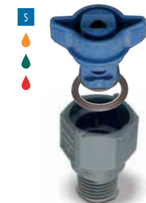
Расп.насадка QPTA + корпус QPPA Соединение с наружной резьбой от 1/4" до 3/8" Наружное уплотнительное кольцо (опция)
