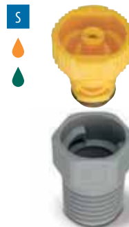
Миниатюрная распылительная насадка QMVV + миниатюрный корпус QPPM Соединение с наружной резьбой от 1/8" до 1/4" Опции: сетчатый фильтр корпуса, сетчатый фильтр насадки и наружное уплотнительное кольцо
