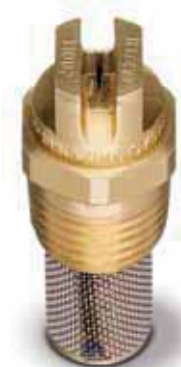
Н-VV и Н-VVL Соединение с наружной резьбой от 1/8" до 1/4" Расход до 1 гал/мин при давлении 40 psi (до 3,8 л/мин при давлении 2,8 бар) Н-VVL со встроенным сетчатым фильтром
