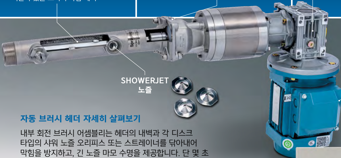
내부 회전 브러시 어셈블리 120° 간격으로 설치된 엇갈린 브러시 섹션이 있는 브러시 타입 헤더
