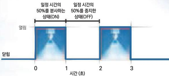
정밀 스프레이 제어(PSC)는 유량을 조절하기 위해 노즐을 매우 신속하게 On/Off 전환하는 작업을 수반합니다. 이 사이클은 매우 빨라서 유량이 거의 일정한 것처럼 보입니다. 일반 노즐의 경우, 유량 조절시 액체 압력의 변화가 필요하며, 이는 노즐의 스프레이 각도/커버리지 및 입자 크기를 변화시킵니다. PSC를 사용하면 압력이 일정하게 유지되어 스프레이 성능의 변화 없이 유량을 바꿀 수 있습니다. PSC는 전기-구동식 스프레이 노즐과 AutoJet 스프레이 컨트롤러를 사용해야 합니다.
