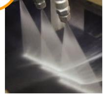
耐摩耗性に優れた独自設計のノズルが鋼材表面に付着したスケールを効率的に確実に除去します。**壊蝕性能向上による節水効果**を見込むことができます。その他様々な工程でノズルが使用されています。
