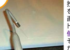
抄紙工程において紙端部を透明で乱れない極細直進流で、シャープにカットします。**原料を効率良く使用**することができます。その他多くの工程でノズルが使用されています。
