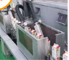
ボトルや紙パックなどに付着している水滴をエアーで除去。エアー源にブロー用い、専用ノズルを使用することで**大幅な電気消費量の削減**効果を得ることができます。
