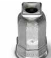
H-WSQ型: 1-1/4"～3" BSPTまたは NPT接続(メスネジ) 着脱可能ベーン、鋳造製ボディ
