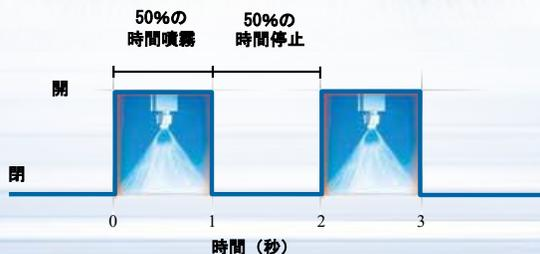
PWM流量制御は流量を制御するために高速でスプレーノズルのオン・オフ制御を行います。このサイクルはとても素早く、流量が一定に流れているように見えるほどです。流量を増やすために圧力を変えるのではなく、デューティーサイクル及びオン・オフ頻度を調節するため、スプレー角度及び粒子サイズは一定に保たれます。PWM流量制御にはPulsaJetスプレーガンとAutoJetスプレーコントローラーが必要です。
