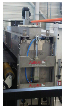
Lubrificateur de bobine pour des bandes jusqu'à 2200 mm de largeur
