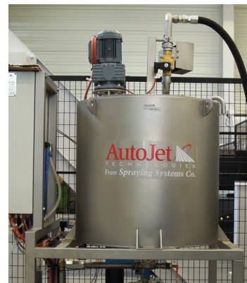
Unité de base présentant la cuve chauffée, chauffage et agitateur en ligne
