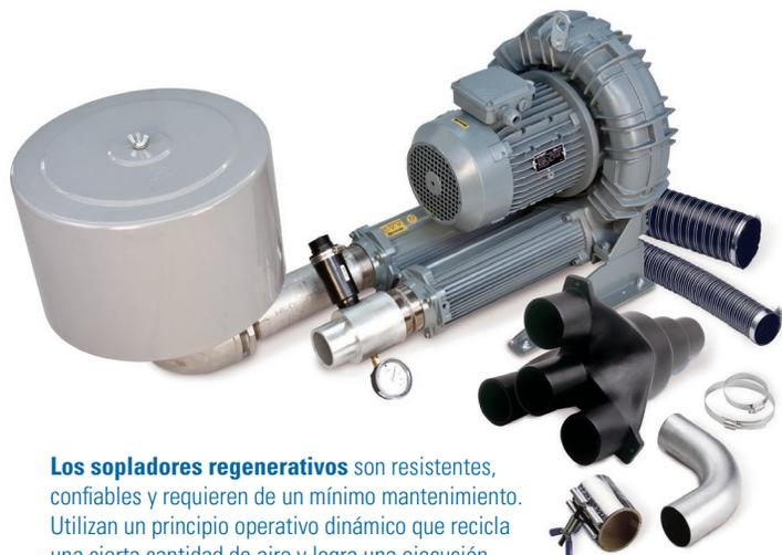
**Los sopladores regenerativos** son resistentes, confiables y requieren de un mínimo mantenimiento. Utilizan un principio operativo dinámico que recicla una cierta cantidad de aire y logra una ejecución comparable a la de muchos sopladores de múltiples etapas o de desplazamiento positivo.
