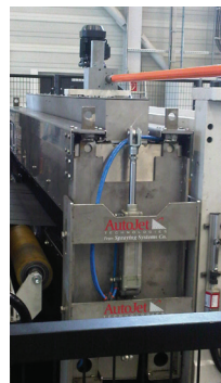
Lubricador de bobina para chapa de 2.200 mm de ancho
