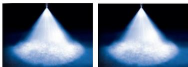
Una de estas boquillas asperja con un exceso del 15 % sobre su capacidad debido al desgaste. Sin embargo, el patrón de aspersión luce idéntico. Asegúrese de revisar si se presentan vetas en el patrón, pero la mejor manera de detectar el desgaste de la boquilla es medir el flujo y la presión.
