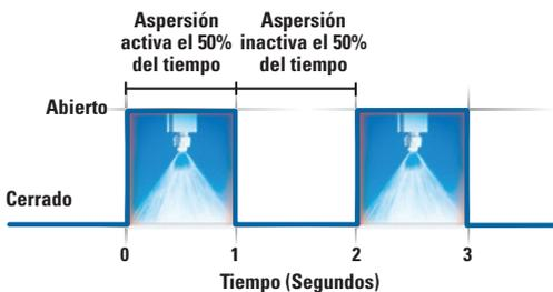
El sistema de aspersión modular AutoJet modelo 1550+ cuenta con control de líquido para un flujo y tamaño de gota adecuados y garantiza la colocación precisa del inhibidor de hongos para minimizar el desperdicio.
