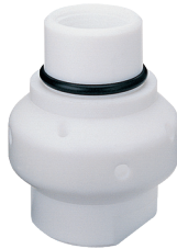
1/2" till 1" BSPT eller NPT Avtagbar O-ring av Viton® för att lätt kunna ta av sprutringen från dyskroppen
