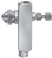
1/4JF och 1/4JFN 1/4" BSPT eller NPT (inv.) tryckluftanslutning 1/8" BSPT eller NPT (inv.) vätskeanslutning
