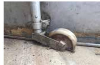
Herkömmliche Schwerlasträder verschleißt durch den Dauereinsatz und die enormen Einwirkkräfte von bis zu 200 kg pro Rad schon nach kurzer Zeit. Die blockierten Räder werden vom Grundräumer mitgeschleift. Dadurch beschädigen sie den Boden des
