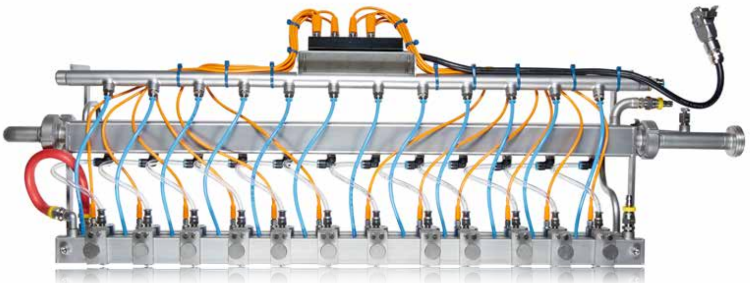
Düsenbalken für PulsaJet Düsen mit variablem Düsenabstand und Temperaturregelung mittels indirektem Wasserkreislauf. Für PulsaJet Düsen AUH und JJAU.
