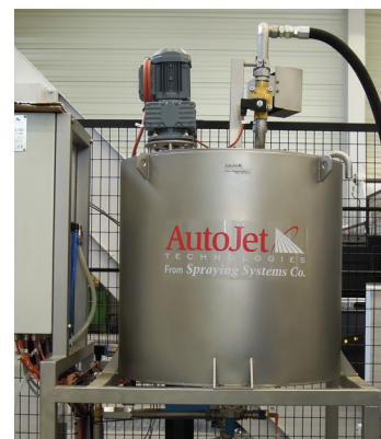
Zentraleinheit mit beheiztem Tank, Durchlauferhitzer und Mischer
