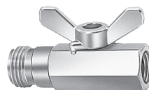
Kulventil/dyskropp 1/4" BSPT eller NPT (utv eller inv) inloppsanslutn. 11/16"-16 UniJet gänga på utloppssidan
