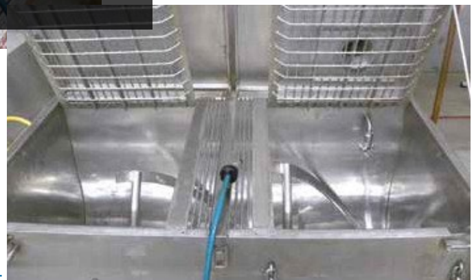
洗浄後のリボンブレンダー
