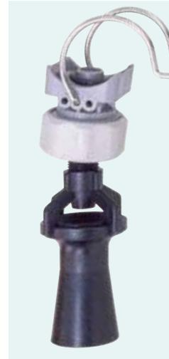
20570型Clip-Eyelet®(クリップ・アイレット)ノズルアセンブリーは、ステンレスバネ材のクランプを既存のヘッダーに押し込むだけで簡単に装着でき、メンテナンスは最小の停止時間で完了します。ヘッダーに取り付けた後はスレッドボールに装着したノズルを嵌め込んで位置決めし、キャップを捻って固定するだけ。全て手作業で行えます。14.3mm(9/16")の孔の開いた1"、1-1/4"、1-1/2"あるいは2"のパイプに適合します。
