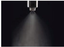
전기-구동식 일류체 노즐 (Electrically-actuated hydraulic nozzle)
