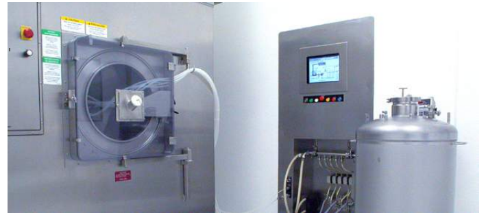
Batch Architect™ 프로세스 제어 소프트웨어를 활용한 정제 코팅기 운영
