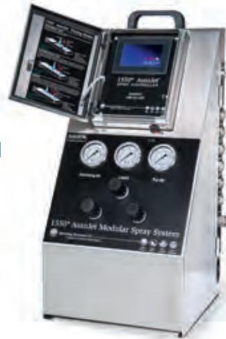
**정밀 스프레이 제어 (PSC)**는 유량을 조절하기 위해 노즐을 매우 신속하게 On/Off 전환하는 작업을 수반합니다. 이 사이클은 매우 빨라서 유량이 거의 일정한 것처럼 보입니다. 일반 노즐의 경우, 유량 조절시 액체 압력의 변화가 필요하며, 이는 노즐의 스프레이 각도/커버리지 및 입자 크기를 변화시킵니다. PSC를 사용하면 압력이 일정하게 유지되어 스프레이 성능의 변화 없이 유량을 바꿀 수 있습니다. PSC는 전기-구동식 스프레이 노즐과 AutoJet 스프레이 컨트롤러를 사용해야 합니다.
