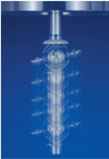
昇降式タンク洗浄装置 RTW シリーズは、スプレーノズルの昇降に最新のブレーキ付ロードレスシリンダーを装備しているため、中間停止精度が大幅に向上いたしました。人手による洗浄に比べ、作業者の安全、省力化、コストダウンが図れ、よりち密な洗浄が可能です。
