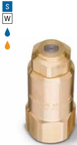
LN型 1/4"BSPTまたは NPT接続(メスネジ) ストレーナー内蔵
