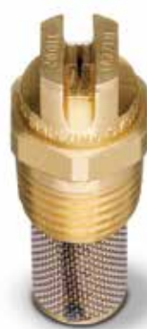
H-VV型/H-VVL型 1/8"~1/4" BSPTまたは NPT接続(オスネジ) 液圧0.28MPa時・流量3.8L/min以下 H-VVL型は専用ストレーナーが含まれます。
