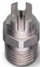
H-VV型/H-VVL型 1/8"~1/4" BSPTまたは NPT接続(オスネジ) 液圧0.28MPa時・流量3.8L/min以下 H-VVL型は専用ストレーナーが含まれます。
