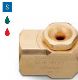
GANV型: 1/4"~1/2"BSPTまたは NPT接続(メスネジ) ベーンレス仕様、着脱可能キャップ
