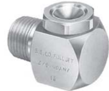
Vane이 없는/분리 가능한 Cap 1/4"~1/2"의 NPT 또는 BSPT (M)
