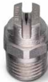
H-VV型/H-VVL型 1/8"~1/4" BSPTまたは NPT接続(オスネジ) 液圧0.28MPa時・流量3.8L/min以下 H-VVL型は専用ストレーナーが含まれます。
